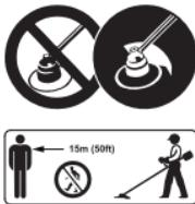
Des objets projetés au loin risquent de causer des blessures graves. Travaillez exclusivement avec le capot protecteur autorisé pour cette débroussailleuse et cette tête fauchuese, et s'assurer que ce capot protecteur est monté correctement. Respecter une distance d'au moins 15 m (50 pi) par rapport à toute personne qui pourrait se trouver dans le voisinage.
