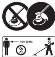
Sussiste il rischio di gravi lesioni per via degli oggetti scagliati. Lavorare soltanto con la protezione montata per il decespugliatore e la testa falciante. Mantenere la distanza minima di 15 m (50 ft.) dalle persone circostanti.
