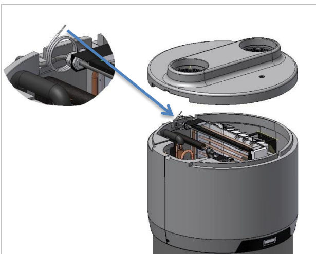
Fig. 14 – Cabluri pentru conectarea la distanță
