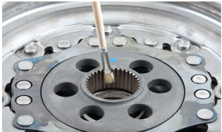
Fig. 1: Trebuie să se aplice puțină vaselină pe canelurile interioare ale VMD ori de câte ori acesta este servizat
