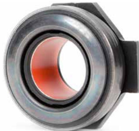
Fig. 3: Rulmenții de presiune cu bucșă din PTFE nu se lubrifiază
