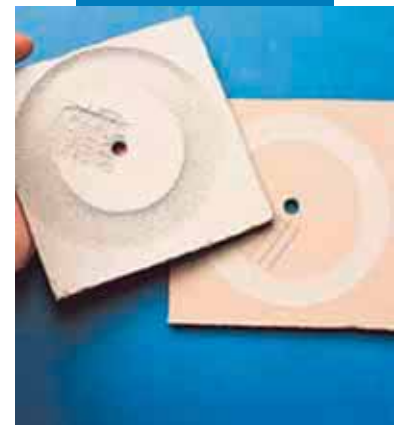
Test de abraziune Taber după 200 de cicluri, executat pe șapă autonivelantă Ultraplan (mostra din dreapta) și pe o șapă autonivelantă normală (mostra din stânga)
