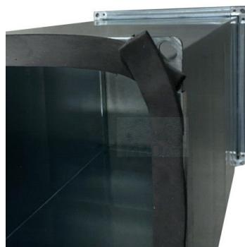
**Pasul 3.** Apropiati cele doua suprafete (capete) ale tubulaturii / pieselor si fixati coltarii cu ajutorul ansamblului surub si piulita. Pentru profil flansa de imbinare de 20 a se utilizeaza suruburi si piulite M8, iar pentru alte dimensiuni ale profilului flansa, suruburi si piulite M10. Fixati si strangeti clipsurile pe profilul flansa de imbinare, astfel incat sa nu existe o distanta mai mare de 400 mm intre doua fixari.
