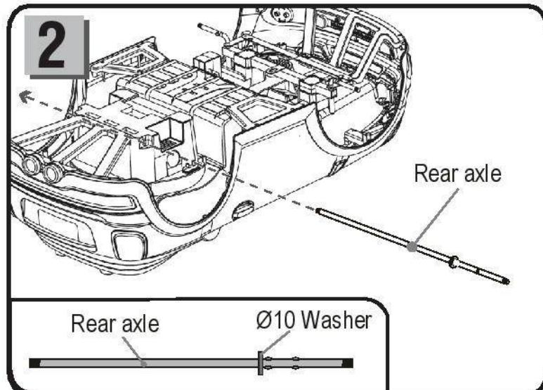
Okrenite karoseriju naopako i zašrafite sa 4 šrafa ojačanje, sa obe strane. Zatim provucite osovinu kroz rupe na karoseriji, kao na slici 2 , prethodno uklonivši sve delove sa nje.
