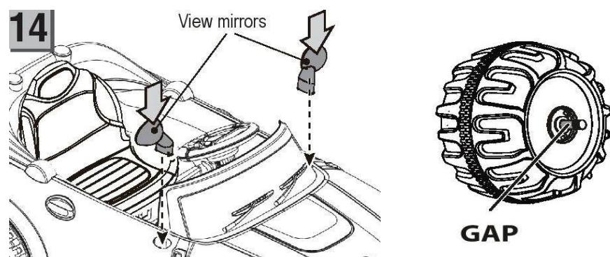
Nakon montiranja bilo kog točka, molimo vas proverite prazninu između točka i navoja. Ako je praznina velika, molimo vas da dodate nekoliko šajbni, ali vodite računa da točak može da se slobodno okreće. Ukoliko se točak teško okreće, smanjite broj šajbnica.
