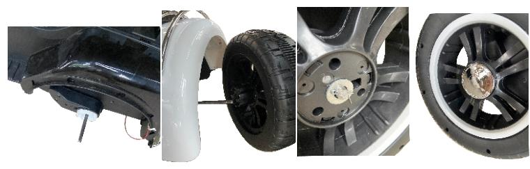
Postavljanje zadnjih točkova: proucrite zadnju osovinu kroz sasiju, postavite točkove. Na osovinu postavite sajbnu i splentu (zakrivite krajeve splente) i zatim postavite poklopac.
