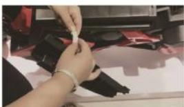
Povezite konektor za papucu gasa sa konektorom koji izlazi iz motora
