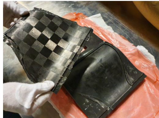
(d) Finished demoulding of PA6-GF test mould
