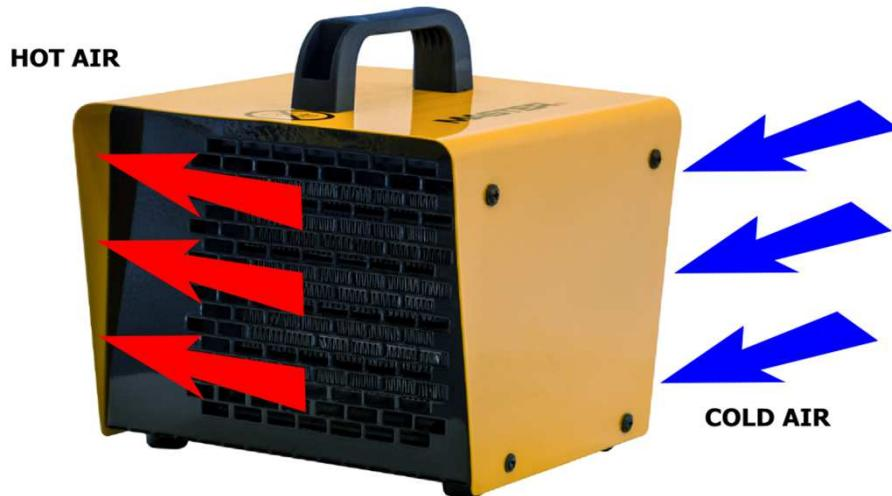
Incalzitorul functioneaza pe principiul convecției forțate. Circulația aerului este realizată cu ajutorul unui ventilator. Aerul rece este aspirat prin partea din spate a incalzitorului. Aerul trece apoi peste elementele de incalzire. Aerul暖 este evacuat prin partea din fața a incalzitorului. Aparatul incalzește la jumătate sau la capacitate maxima. Aparatul este echipat cu protecție termică automată. Incalzitorul are un reglaj termostatice ce poate regla temperatură în plaja 0°C - 40°C.
