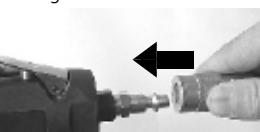
6. Retirez le bouchon de l'entrée d'air et branchez le tuyau d'air à l'appareil.
