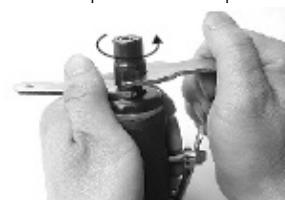
3. Odšroubujte příruba, za tímto účelem uchopte jedním klíčem vřeteno, druhým klíčem kryt a šroubujte proti směru pohybu hodinových ručiček.
