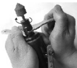
5. Fixez l'embout à l'appareil. Pour cela, placez une clé derrière le mandrin et une autre clé doit être placée devant la protection. Puis tournez dans le sens des aiguilles d'une montre.
