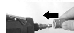
6. Rimuovere il cappuccio del getto d'aria e collegare il tubo dell'aria al dispositivo.
