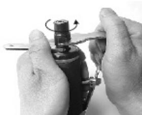
3. Należy odkręcić kołnierz, w tym celu należy złapać jednym kluczem za wrzeciono, drugim kluczem chwycić za osłonę i odkręcić w kierunku przeciwnym do kierunku wskazówek zegara.
