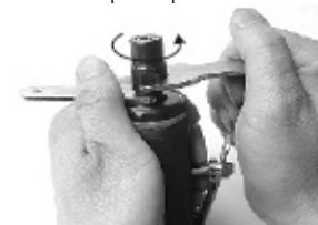
3. Desmonte el mandril, girando el eje con 2 llaves en sentido contrario, como se muestra en la foto.
