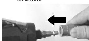
6. Retire el tapón de entrada de aire y conecte la manguera al equipo.
