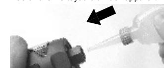
Versez quelques gouttes d'huile dans l'entrée d'air. Branchez ensuite le tuyau d'air et allumez l'appareil pendant quelques secondes pour que l'huile se propage. ATTENTION! L'équipement doit être graissé tous les jours une fois la préparation terminée! ATTENTION! Lors d'une pause plus longue, versez 5 gouttes d'huile et laissez l'appareil allumé environ 30 secondes avant son utilisation.
