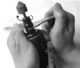
5. Należy zakręcić końcówkę w urządzeniu. W tym celu należy złapać jednym kluczem za wrzeciono, drugim kluczem należy chwycić za osłonę i zakręcić zgodnie z kierunkiem wskazówek zegara.
