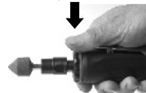
7. Zařízení zapněte uvolněním blokády tlačítka a stisknutím tlačítka.
