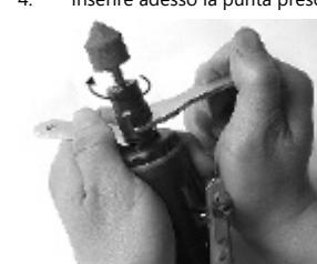
5. Fissare la punta al dispositivo. Con l'aiuto di una chiave fissare il mandrino in senso antiorario. Con l'altra chiave tenere quindi la copertura. Girare adesso in senso orario.
