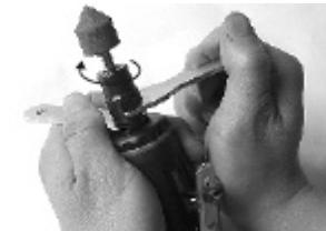
5. Das Aufsatzstück am Gerät festdrehen. Dazu mit einem Schlüssel hinter der Spindel fassen, der andere Schlüssel muss von der Abdeckung greifen. Dann im Uhrzeigersinn zudrehen.
