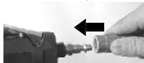
6. Entfernen Sie die Kappe vom Lufteinlass und schließen Sie den Luftschlauch an das Gerät an.
