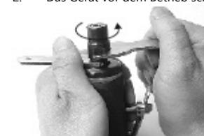
3. Schrauben Sie den Flansch ab, indem Sie mit einem Schlüssel hinter die Spindel greifen, die Abdeckung mit der anderen Taste ergreifen und gegen den Uhrzeigersinn herausdrehen.
