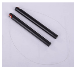
Lanko s držáky pro oddělování obrazovky displeje.
