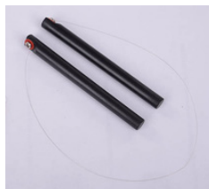
Alambre con asas para separar las pantallas.
