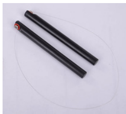
Filo da taglio con maniglie per staccare il display
