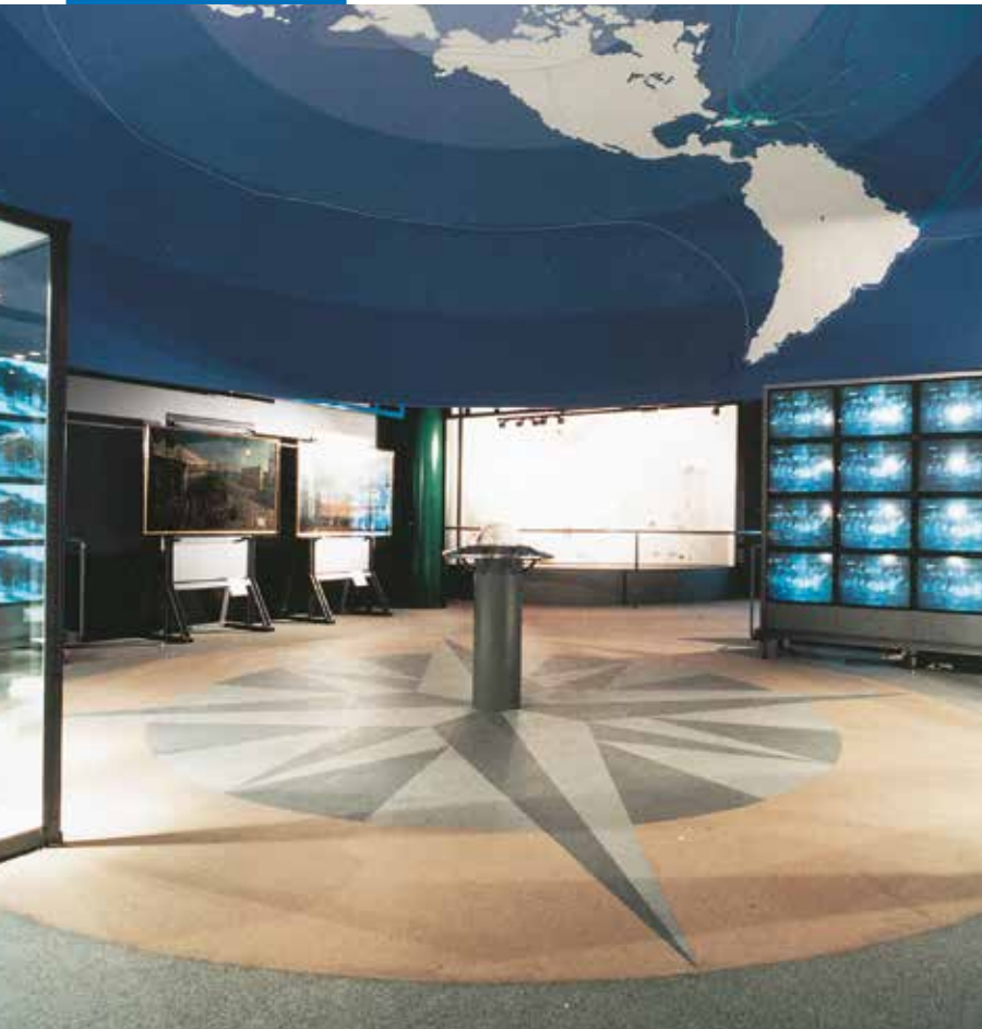
Standul expozițional italian EXPO'92 din Sevilla. Pardoseala din PVC Esalux-Liuni lipita cu Adesilex V4
